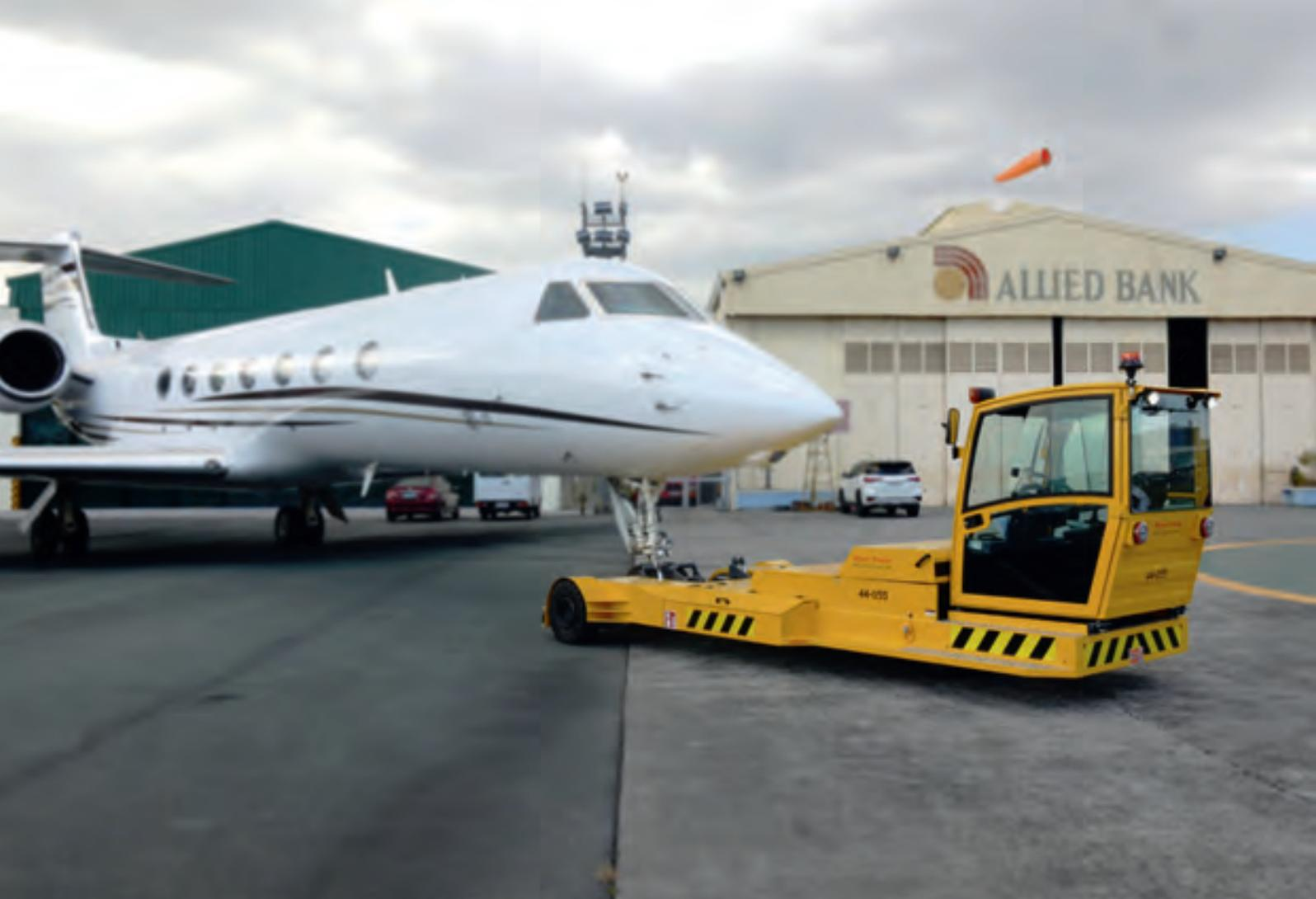
Bugradaufnahme vollautomatisch über Greifer
