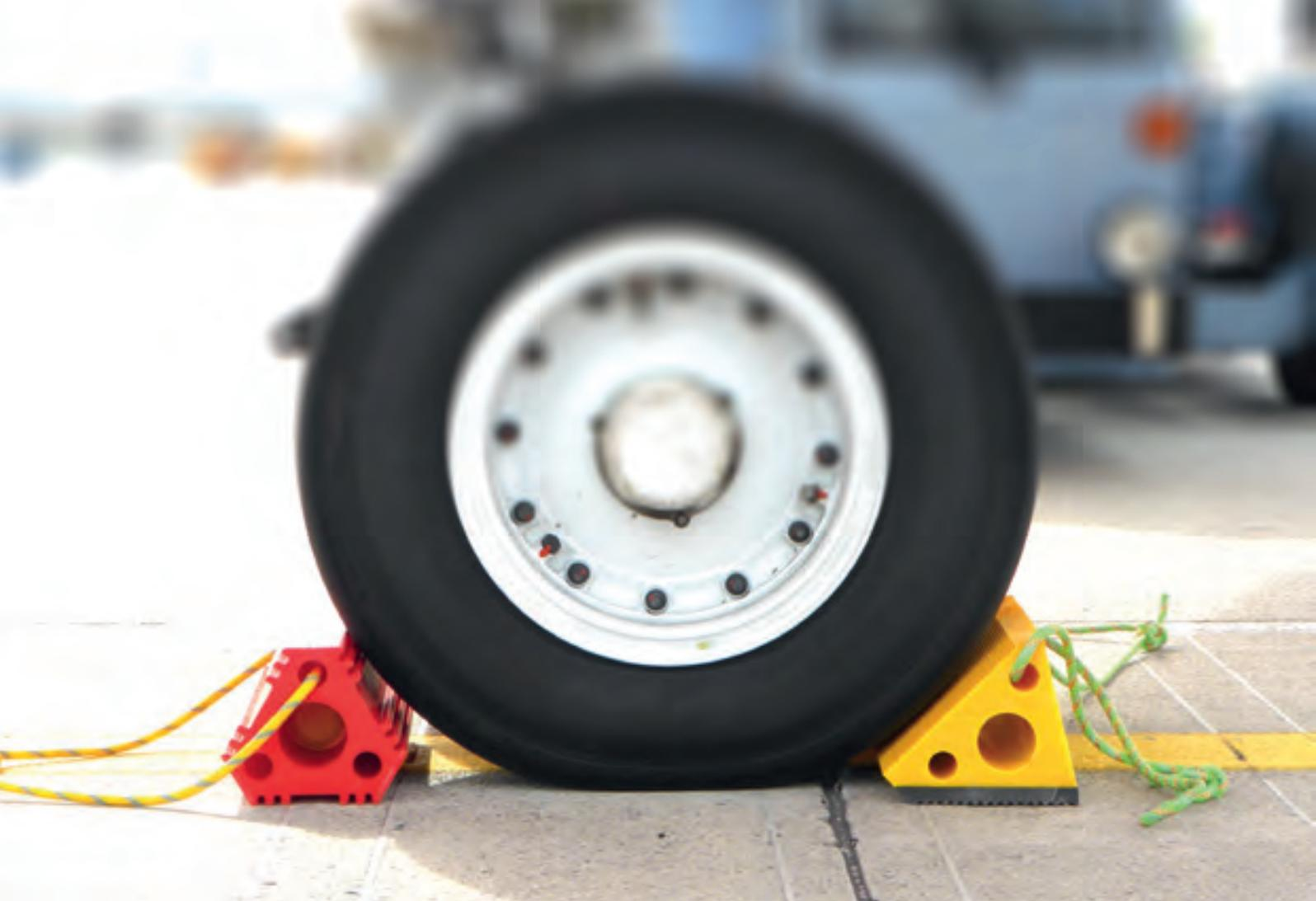
Querrillen auf Schräge verhindern ein verschieben der Chocks durch Flugzeugrad
