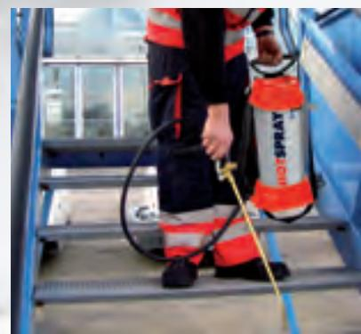
HOTSPRAY Deicer ist ein tragbares, elektrisch beheizbares Hochdruckspritzgerät für Enteisungsflüssigkeiten. Lieferung mit Schlauch, Ventil und CE Zulassung.
