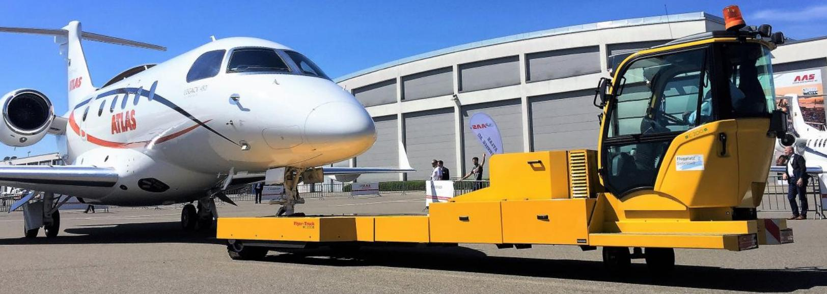
Flugzeugschlepper von Flyer-Truck sind für Flugzeuge mit einem maximalen Abfluggewicht von 100to geeignet.
