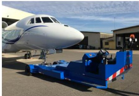
*Elektrisch angetrieben: FLT 400 e-drive*
