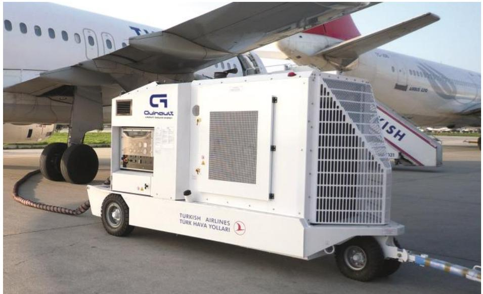
Ein unverzichtbarer Helfer im Notfall: das Luftstartgerät
