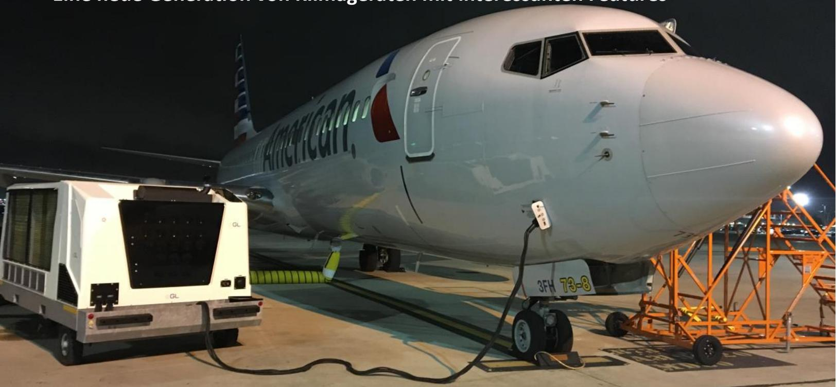
Eine Besonderheit: ein Gerät für 400Hz Bodenstrom und zugleich Klimatisierung.
