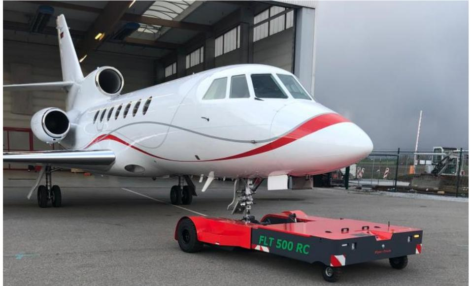
*Der FLT 500 RC ist für Flugzeuge und Hubschrauber bis 50,0to max. Abfluggewicht geeignet.*
