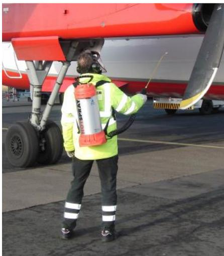
Helfer bei der Propeller-Enteisung
