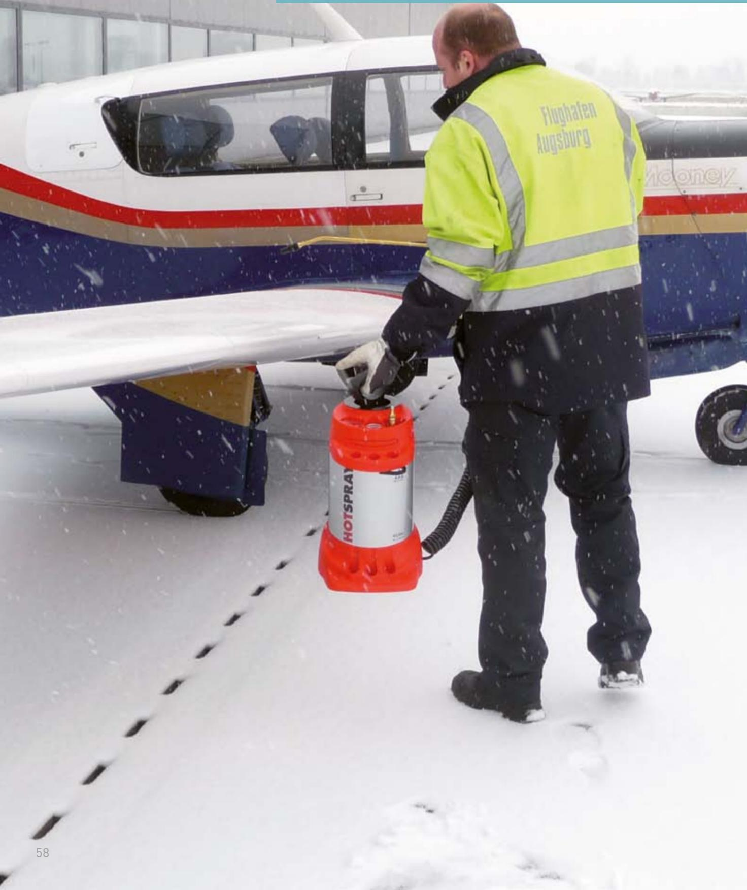
HOTSPRAY Deicer ist ein tragbarer, elektrisch beheizbares Hochdruckspritzgerät für Enteisungsflüssigkeiten. Lieferung mit Schlauch, Ventil und CE Zulassung. Heizelement wird herausgenommen für geringeres Tragegewicht.
