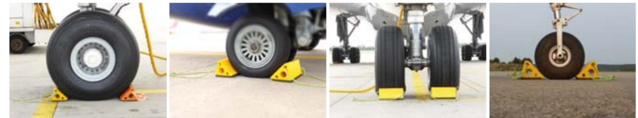
Querrillen auf Schräge verhindern ein Verschieben der Chocks durch Flugzeugrad
