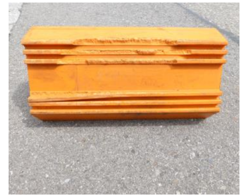
Typisches Schadensbild eines Chocks.
