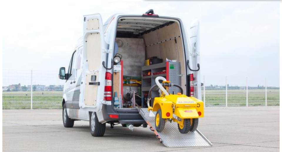
Das Reinigungsfahrzeug wird von einem Servicewagen mit Frictiontester begleitet
