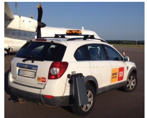
MARWIS seitlich am Fahrzeug montiert: hier im Einsatz am Flughafen Saarbrücken
