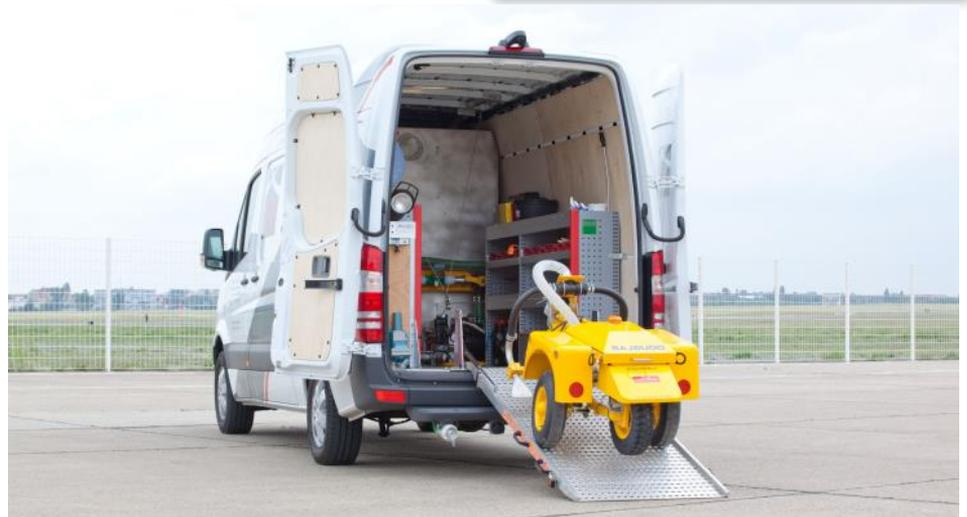
Das Reinigungsfahrzeug wird von einem Servicewagen mit Frictiontester begleitet
